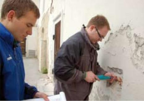
Mit speziellen Messgeräten wird die Festigkeit des Mauerwerks analysiert.
